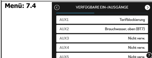
Zur Aktivierung der Tarifblockierung bei zweischieniger Stromversorgung und den Brauchwasserfühler BT7 welcher als Anzeigewert dient
