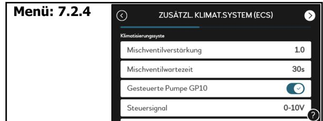
Einstellungen zum 2. Heizkreis (Klimatisierungssystem 2) Steuersignal muss bei proportionaldruck geregelter Umwälzpumpe nicht berücksichtigt werden
