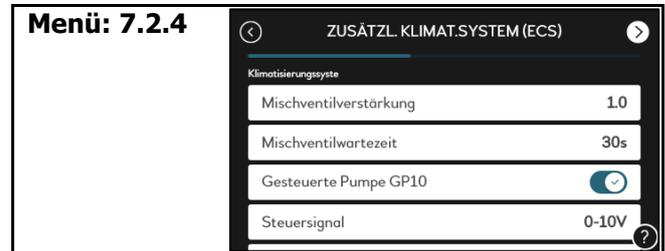
Einstellungen zum 2. Heizkreis (Klimatisierungssystem 2) Steuersignal muss bei proportionaldruck geregelter Umwälzpumpe nicht berücksichtigt werden
