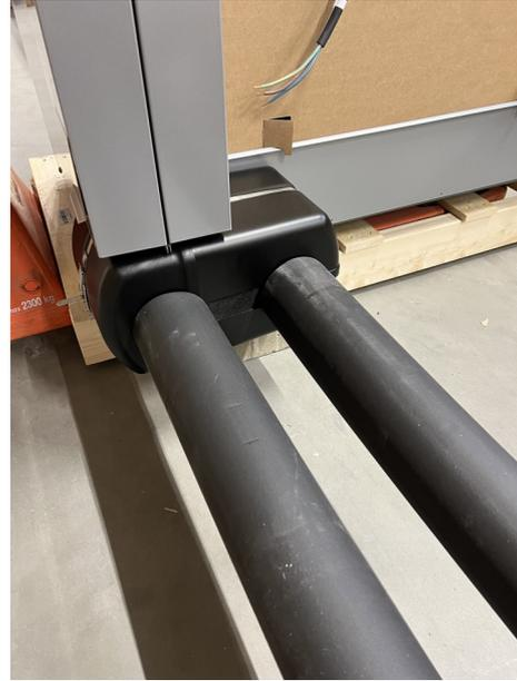
8. Zweite (200%) Dämmung inkl. UV und Bisschutz anbringen und verkleben
