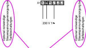
Bei einer separaten Spannungsversorgung müssen die Brücken der Klemme X5 entfernt werden. Siehe Installateurhandbuch "Anschluss externe Spannungsversorgung"
