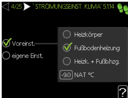
1. Vorhandenes Heizsystem wählen, um das Delta T zw. VL & RL zu bestimmen
