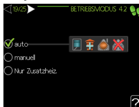
11. Betriebsmodus der Wärmepumpe festlegen. Ist die Anlage komplett gefüllt und fertiggestellt „Auto“
