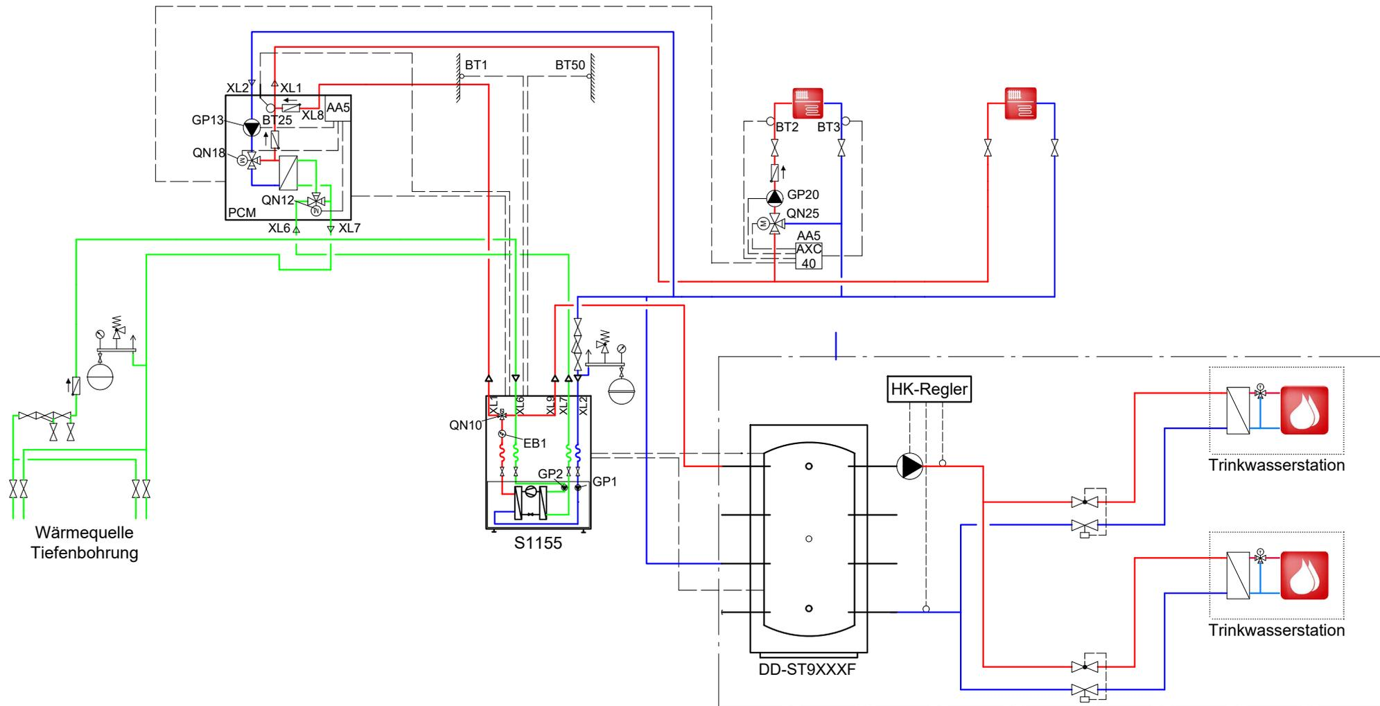
Dies ist eine Beispielhydraulik. Der Anschluss muss nach Vorgaben des Herstellers der Trinkwasserstation erfolgen.
