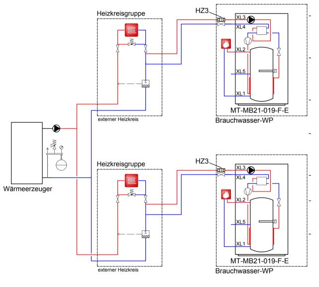
Systemtemperatur 10°C bis 50°C ohne internen Zusatzwärmetauscher und max. Wärmequelleneintrittstemperatur von 55°C
