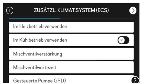
Aktivieren Sie die Funktionen für die das zusätzliche Klimasystem verwendet werden soll. Steuersignal muss bei proportionaldruck geregelter Umwälzpumpe nicht berücksichtigt werden
