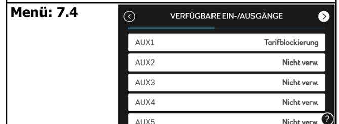
Zur Aktivierung der Tarifblockierung bei zweischienige Stromversorgung
