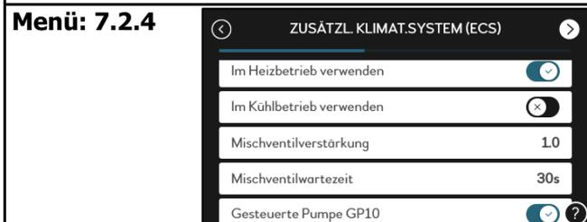
Aktivieren Sie die Funktionen, für die das zusätzliche Klimasystem verwendet werden soll. Steuersignal muss bei proportionaldruck geregelter Umwälzpumpe nicht berücksichtigt werden
