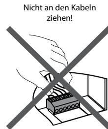
Den Anschlussstecker mit einem Schlitzschraubenzieher lösen
