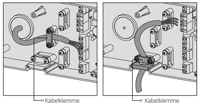
7. Die Patrone in das Lüftungsrohr einsetzen, wie unten abgebildet. Bei der Montage darauf achten, dass der Pfeil nach oben zeigt. Dann das Stromkabel fixieren und den Anschlussstecker an die Leiterplatte anschließen.
