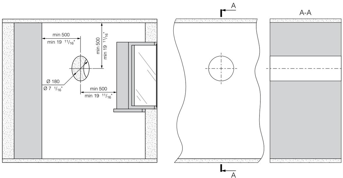
2. Das Lüftungsrohr in die Wand einsetzen. Das Rohr mit Hilfe der mitgelieferten Styropor-Keile und Montageschaum fixieren. An der Außenwand muss das Lüftungsrohr um die Länge herausragen, die für die Montage der Außen-Lüftungshaube erforderlich ist. Details finden Sie in der Montageanleitung für die Lüftungshaube.
