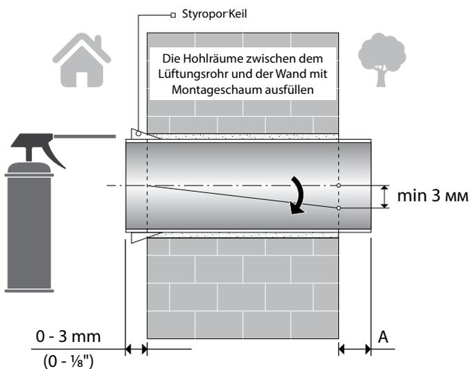
Das Lüftungsrohr in die Wand einsetzen, wie links abgebildet. Das Lüftungsrohr mit einem Mindestwinkel von 3° nach unten in die Wand einsetzen.
