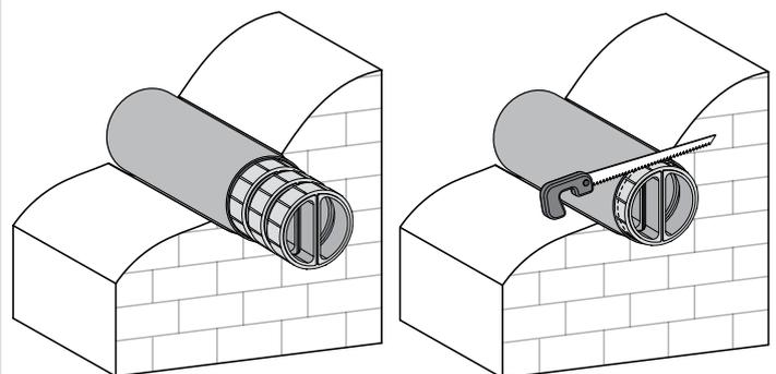
10. Die Lüftungshaube montieren. Die Montage der Außenhaube ist in der Montageanleitung für die Lüftungshaube dargestellt.
