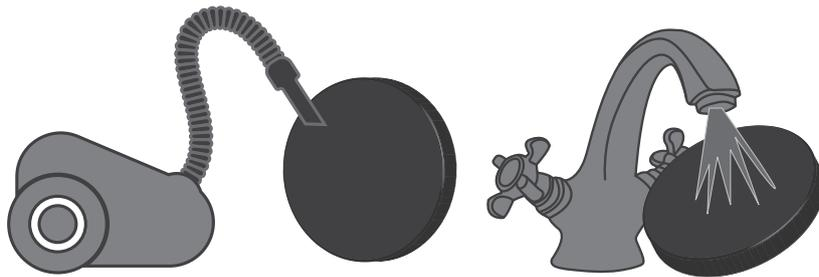
Auch bei regelmäßiger Wartung am Filter, können Staubpartikel auf den Wärmetauscher gelangen.
