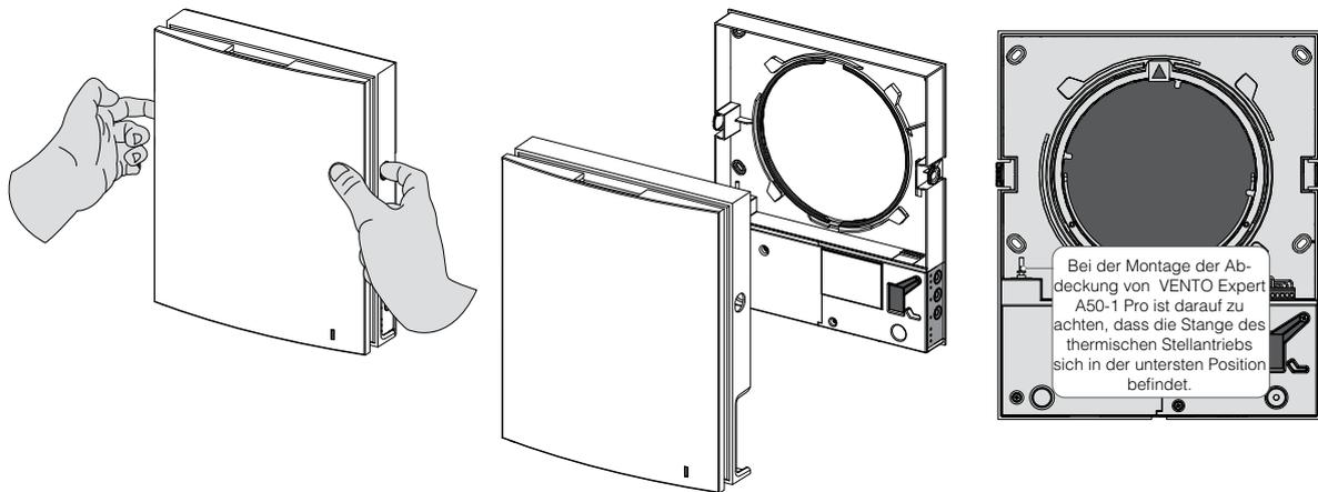
5. Die Rückseite des Innenelementes mit den mitgelieferten Schrauben an der Wand befestigen. Die zwei Schrauben, welche den transparenten Deckel fixieren, herausdrehen, um den Zugang zu den Anschlussklemmen frei zu machen.
