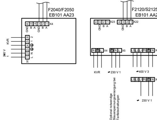
Bei einer separaten Spannungsversorgung müssen die Brücken der Klemme X5 entfernt werden. Siehe Installateurhandbuch "Anschluss externe Spannungsversorgung"
