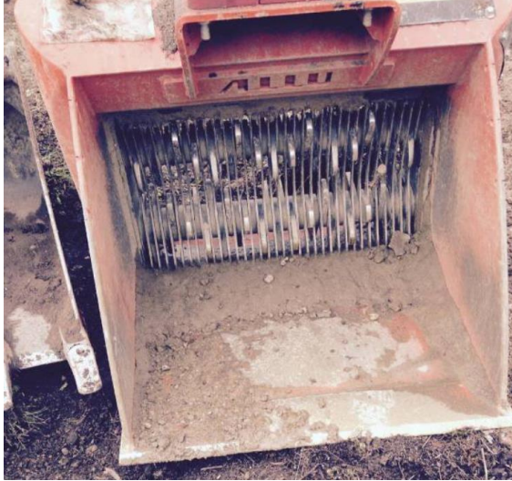
Siebschaufel zum Aufbereiten (Reitern) des Aushubs bei Bedarf
